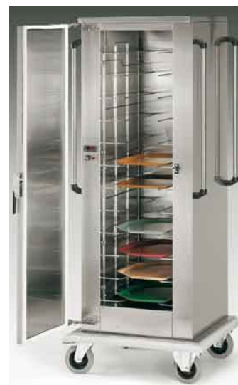
Ogrevani voziček Dim. 780x730xh1900mm Moč 1600W Kapaciteta 12 termoportov EN (530x370xh120mm) GN (530x325xh120mm)
