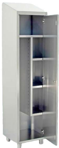
Večnamenska omara Inox AISI 304 Nastavljivi polici in nogice Ključavnica Reže za prezračevanje Dolžina 500mm in 1000mm Globina 500mm Višina 2150mm
