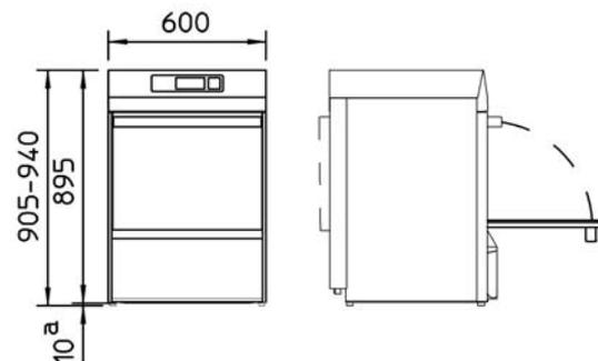
Die vertikalen Maße können bei Bedarf durch verstellbare FüÙe um bis zu 35 mm erhöht werden.
